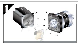
Motor und Getriebe Baugrosse kontrollieren und Planlagenflächen fettfrei reinigen.
